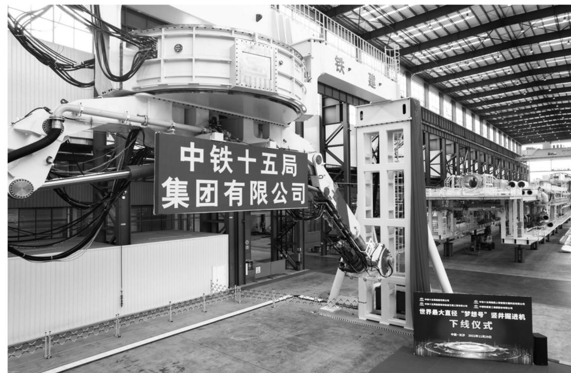
11月29日,由我国自主研制的超大直径竖井掘进机“梦想号”在长沙下线。“梦想号”整机高约10米,开挖直径达23.02米,标志着我国地下空间领域工程装备科技攻关及应用又上新台阶。新华
