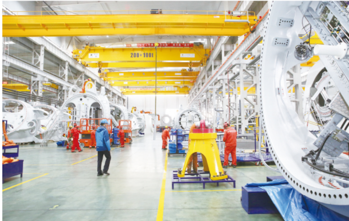
日前,全风科技临海总装厂项目现场内,技术人员在安装风电电机。该项目拥有年产6兆瓦及以上海上风电机组100台(套)、计600兆瓦的大型海上风电机组生产能力,已建成国内检测能力领先的研发实验检测中心和海上大容量智能化生产工厂。王越摄
