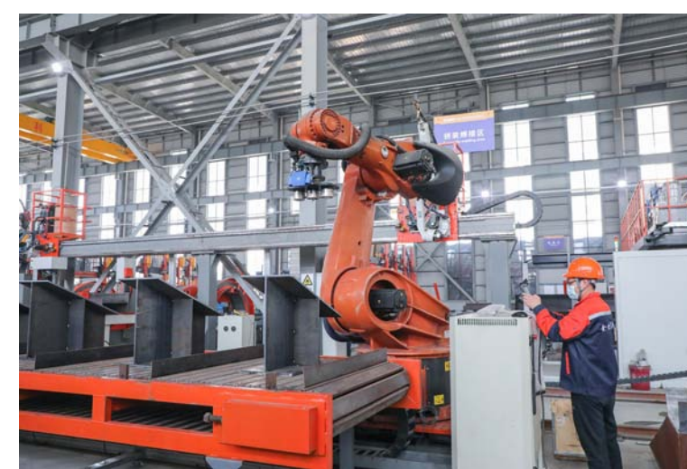
溱东镇金之鑫金属结构件项目新上激光切割机、库卡机器人、安川机器人和全自动钢结构生产线等设备,专注精致钢、结构件、钣金件的生成、设计和研发,是卡塔尔世界杯卢赛尔主体育场、卡塔尔塔楼、马来西亚地铁站、重庆国际金融中心、深圳交易所等建筑部件的优质供应商。 记者 张莉琳 摄
