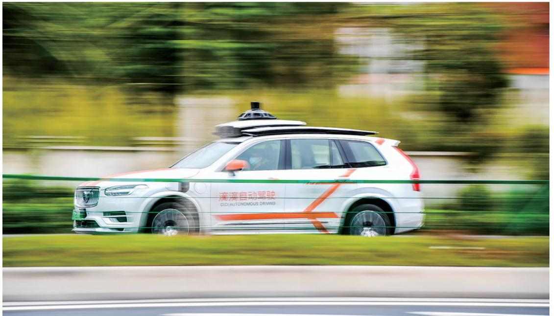
近日,位于安亭镇的上海滴滴沃芽科技有限公司对智能网联出租车进行升级,新引进沃尔沃XC90作为未来主力网约车型,搭载滴滴双子星硬件平台,可实现四重冗余系统,达到ASIL-D最高等级安全,使车辆即使在极端天气和复杂路况下,也能表现稳定。
