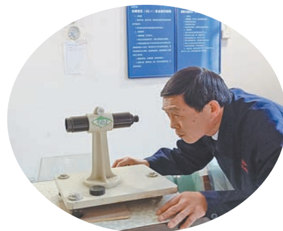
董保才在检测汽车挡风玻璃副像偏倚技术。本报记者 李新和 摄
