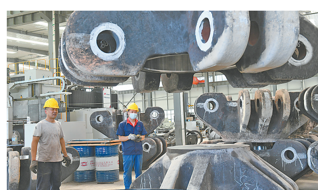
7月8日,焦作天宝恒祥机械科技有限公司的工人在生产大型六面顶金刚石压机配件。该公司专业生产超硬材料高压合成大型智能化六面顶设备和金刚石超硬材料,国内市场占有率稳居行业第一位。 本报记者 刘金元 摄
