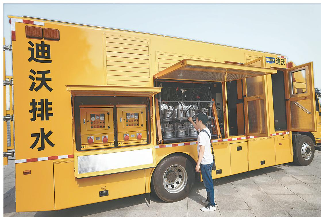
7月31日上午，焦作供电公司一辆大型排水装备在白鹭湿地公园开展实操培训。该装备在业界被称为“龙吸水”，是河南省电力公司为豫西北电网防汛工作增添的新装备。焦作供电公司相关负责人介绍，“龙吸水”主要用于各级电网防汛抗灾准备，车上搭载有发电机组、应急照明设备、8台便携式潜水泵等专用设备，排水能力达4000立方米/小时，在提升电网防汛能力的同时，还可以为地方防汛工作保驾护航。
