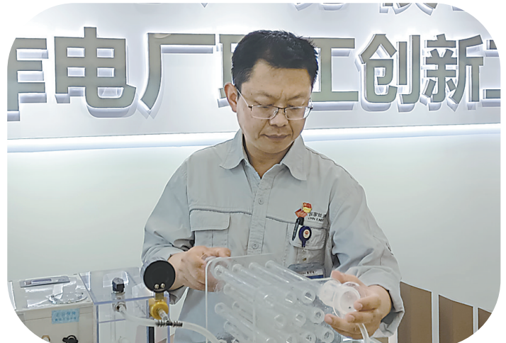
王云峰在创新工作室进行单根换热管查漏装置试验。 本报记者 李新和 摄
