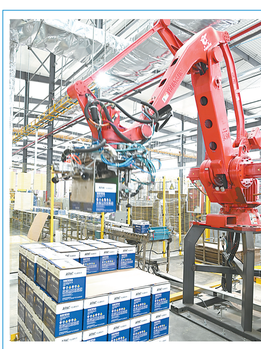
8月26日,河南超威正能源有限公司成品车间的码垛机器人在摆放电池。该公司由河南超威能源有限公司与德国Moll公司合资组建,专业生产汽车用起停、起停电池,是我省重点建设项目。近年来,超威正能源研发出了SLI、EFB、AGM三大技术系列的105个规格品种电池,年产量达1850万只。本报记者 杨帆 摄
