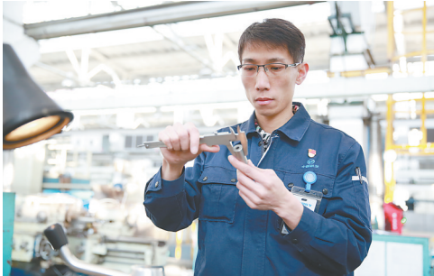
洪家光在车间用卡尺测量加工的工具零件（2018年1月3日摄）。（新华社发）
