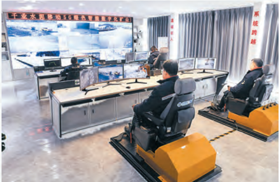
数字赋能产业升级。图为千业水泥提升5G绿色智能数字化矿山控制室。 本报记者 刘金元 摄
