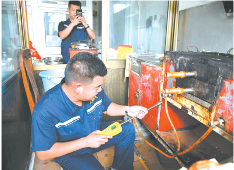
燃气公司专业人员帮助商户检测液化气罐阀门和燃气灶口的密封性能。
