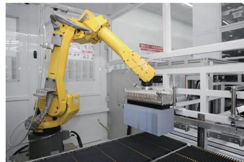
太阳能电池片自动化生产线
