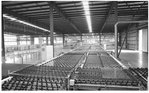
凯盛(自贡)新能源有限公司太阳能超高压延光伏玻璃生产线
