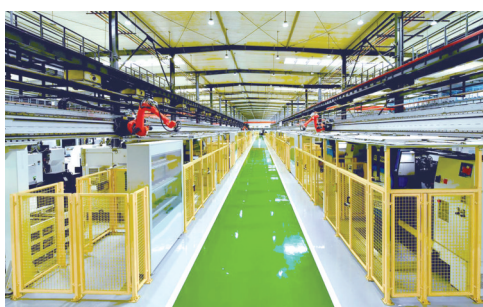
东方汽轮机国内首个叶片加工无人车间及首条黑灯产线
