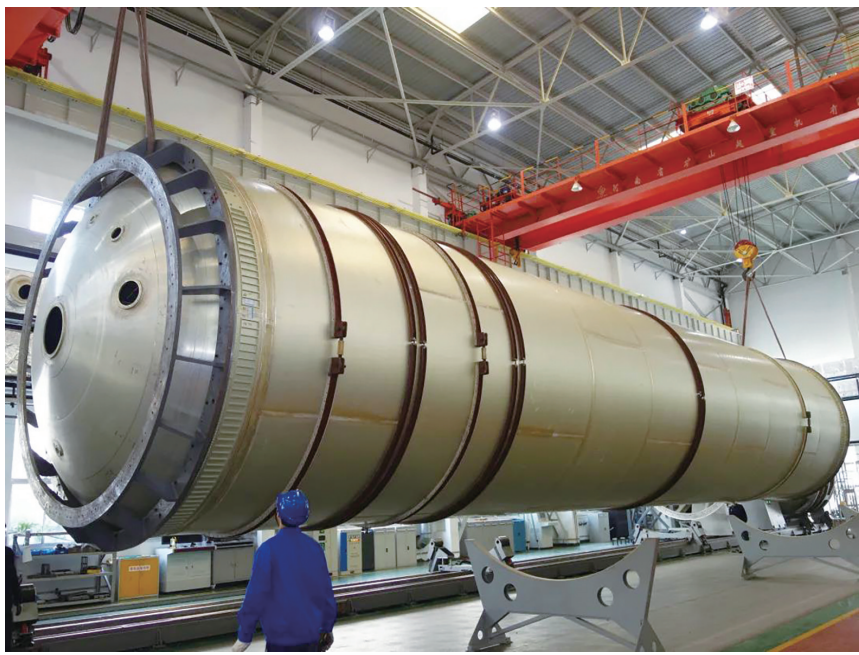
图为目前国内最长的运载火箭推进剂贮箱之一。 通讯员 摄
