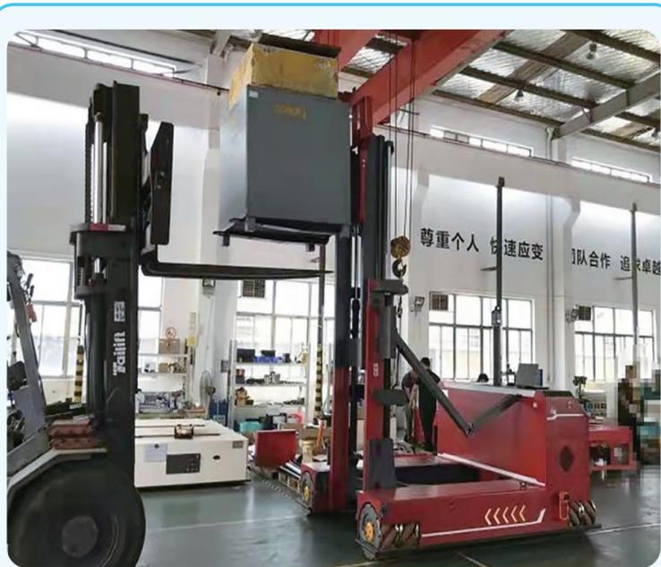
图为技术人员正在对前移式叉车性能进行测试。
