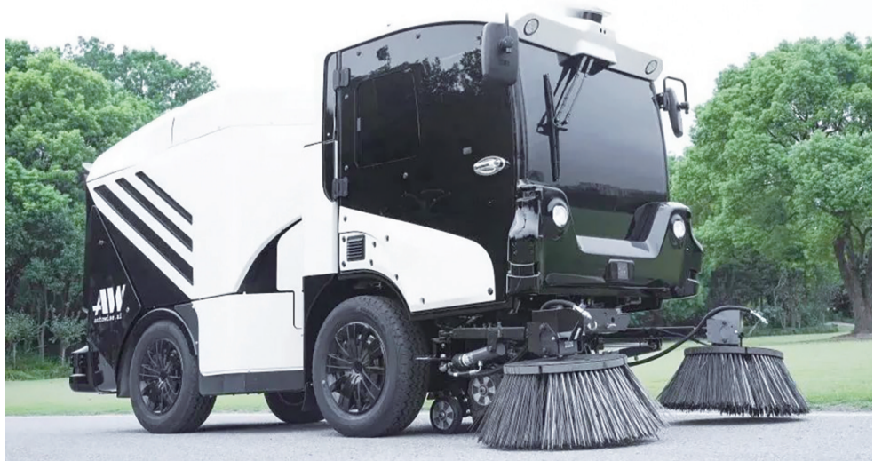
仙途智能第四代自研AW Roboard-X不仅实现了Roboard与上装X的完全分离,感知设备、线控系统、计算模块等软硬件技术也得到全面优化与提升。 受访者供图
