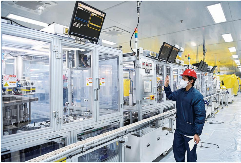
连日来,东阳市东磁高新产业园区的技术人员正加快推进高性能锂电池生产设备安装调试工作,争取早日实现投产。据了解,横店集团东磁股份有限公司将在这里建设4条高性能锂电池智能生产线,新增年产6GWh高性能锂电池的产能。项目通过5G融合应用终端规模部署,打造锂电池“未来工厂”。
