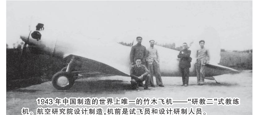
1943年中国制造的世界上唯一的竹木飞机——“研教二”式教练机。航空研究院设计制造,机前是试飞员和设计研制人员。
