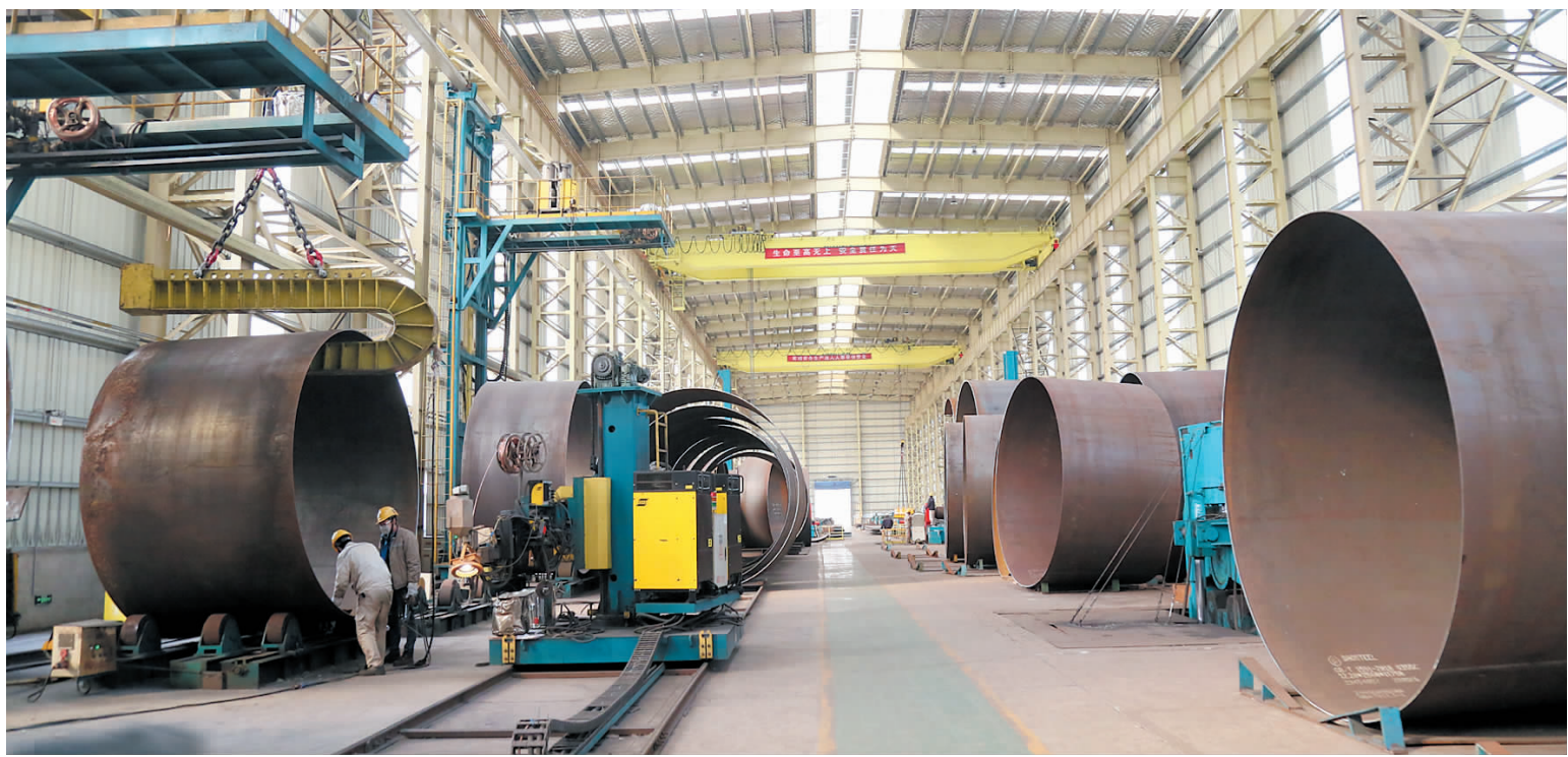
江苏天能海洋重工有限公司是我县一家海上风电配套基础管桩和塔筒制造、销售的企业,产品品质优良、承载力强,最大口径已经升至9米,长度超过74米,先后与三峡集团、鲁能、华能等公司展开合作。图为该公司车间一角。 记者 叶珊珊 摄
