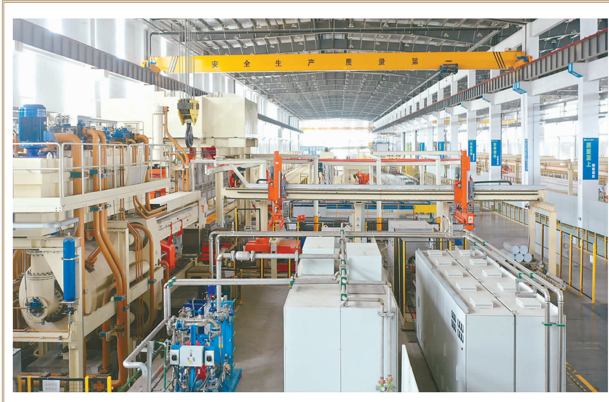
江苏高卡轻合金有限公司拥有国际领先的布萊賽茨挤压机、欧玛福后辅、铝棒感应加热炉及时效炉等设备,依托高速挤压、超级加热、在线淬火、快速热处理的先进工艺,产品重量仅为铁部件的三分之一,强度更胜一筹。记者 张佳奇 摄
