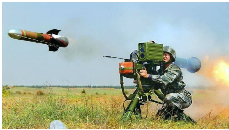
发射后的“红箭”8正在展开卷弧式弹翼,落下的白色物体是弹翼折叠时的衬垫
