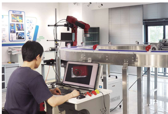
AI视觉检测设备对汽车螺母焊接件进行检测。
