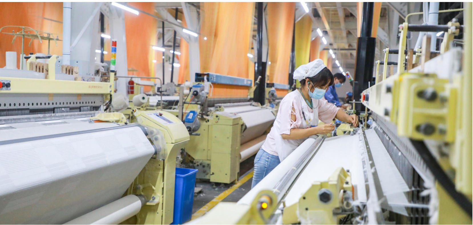
唐洋镇明源纺织引进国内行业领先的自动化喷气织机、智能化宽幅、自动穿箱机、高速电子大提花喷气织机等智能化设备，生产规模位居国内家纺业第三。目前，企业正打足产能，满足市场需求。记者 张莉琳 摄
