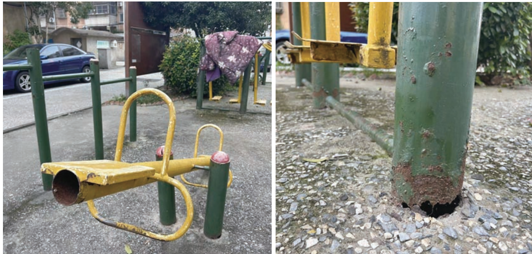
图为铸铁部件腐蚀甚至断裂的健身器材。 记者 贺丽华 帅莹 摄
