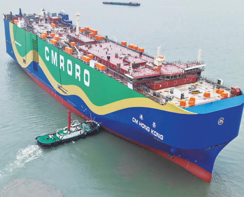
日前，由招商轮船订造、招商工业海门基地承建的全球首艘9300车甲醇双燃料动力汽车滚装船成功下水，标志着该船建造取得关键进展，为新船按期交付奠定坚实基础。该船是目前全球在建的最大载量甲醇双燃料动力汽车滚装船，是招商轮船打造的系列甲醇双燃料动力汽车滚装船的首制船，标志着我国在绿色智能大型汽车滚装船舶建造领域取得重大突破，为全球汽车滚装船低碳转型提供创新样本。
