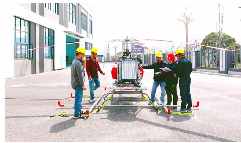
本报讯 近日，建德航空小镇内的领军企业浙江华奕航空科技有限公司（以下简称华奕航空）传来喜讯，首架中大型无人直升机样机出炉，目前进入系留试验阶段。
