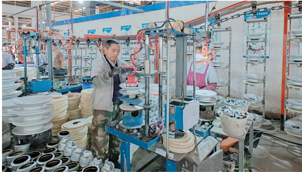
品目前上半年订单已经排满，产品集中在5、6月份出货。工人们正有条不紊地赶制订单。企业主要生产瓷棒式绝缘子、近日，在位于边城镇的江苏南瓷绝缘子股份有限公司，巫彤 步婷 摄影报道
