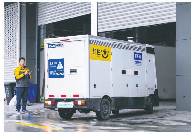
装进车厢,一辆搭载2个激光雷达和12个摄像头的无人车便会自动驶向驿站。这辆无人车能感知120米范围内的人、车、物,严格按照规划路线运行,单次可装载200余件快件,24小时不间断工作。
