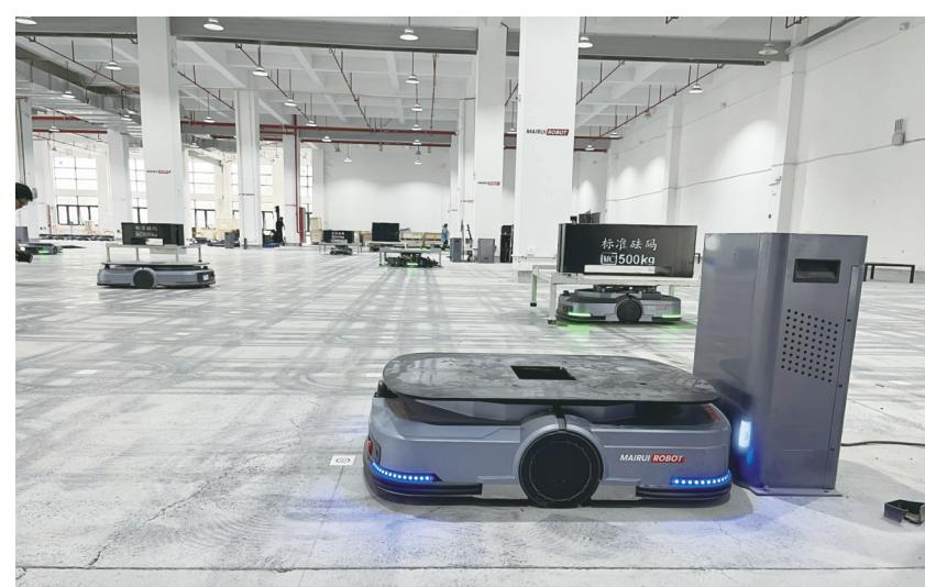
AMR产品线涵盖L2、L3、L5和L8多种型号,负载范围从400kg至2000kg,可适应制造场景中多样化的物流搬运需求。
