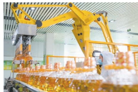
在长寿花食品股份有限公司,工业机器人在抓取玉米油。
