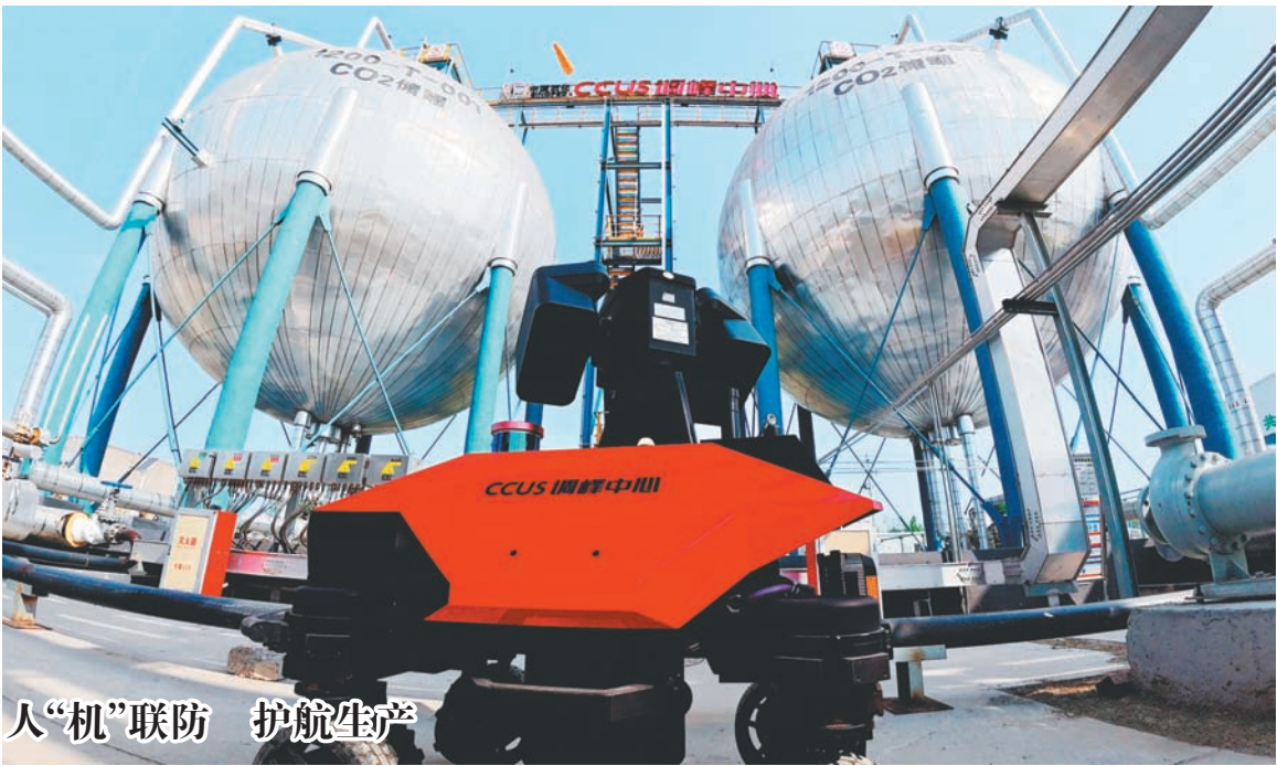
华东石油局液碳公司CCUS调峰中心智能巡检机器人系统投入巡检近一年来，实现人机协同安全管控升级。机器人搭载红外热成像、气体检测阵列等7类传感器，对二氧化碳提纯装置实施360°全息扫描，实时捕捉设备温度漂移、管线微泄漏等隐患。系统采用动态路径规划算法，自主避障精度达±2厘米，配合人工复检形成“AI预警—中控研判—人工处置”闭环。投运以来，关键生产区域人工巡检频次降低60%，隐患识别响应速度提升至15秒级，构建起覆盖压力、温度、密封性等12项核心参数的立体安防网，为CCUS调峰中心实现本质安全提供智能化解决方案。
