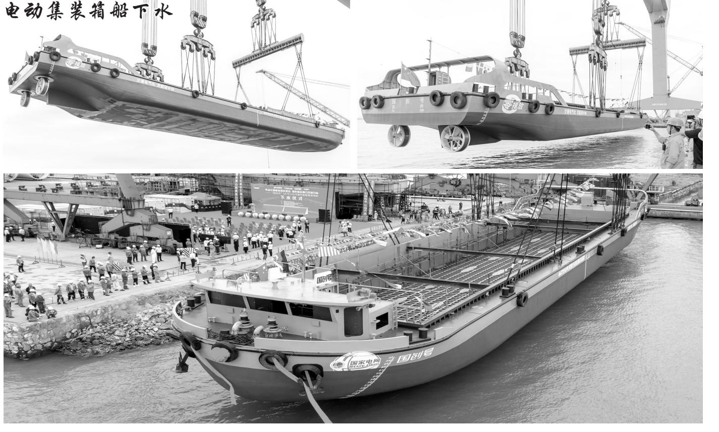
泰州三福船舶工程有限公司为国网智慧能源交通技术创新中心(苏州)有限公司建造的纯电动集装箱船“国创号”日前在泰州高港正式下水。“国创号”是全国首艘64TEU标准化智能新能源集装箱船,总长64.95米、型宽12.5米、型深3.4米,总吨位994吨,以8节的速度不间断巡航174公里以上,入选中国船级社,并在我国水运交通领域创下多项第一,更加绿色环保、智慧安全和经济高效。
