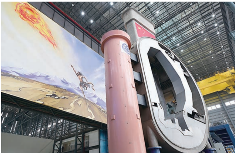
日前,专家组对聚变堆主机关键系统综合研究设施八分之一真空室及总体安装系统进行测试和验收。该系统不仅为未来聚变堆主机真空室内部件的安装、检测、调试和遥操作研究提供一个全尺寸的综合实验平台,相关技术还拓展应用于粒子加速器、精密机械、电子科技、半导体等领域。
