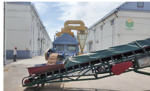
姜堰储备粮公司今年购置脉冲除尘杂筛2台、智能型吸粮机1台,利用罩棚对输送机进行封闭处理,尽量缩短抓斗与车厢间距,张开抓斗卸粮时缓慢打开、掌握开合、控制流速,治理扬尘效果显著。图为稻谷入库现场。 顾翔宇 摄
