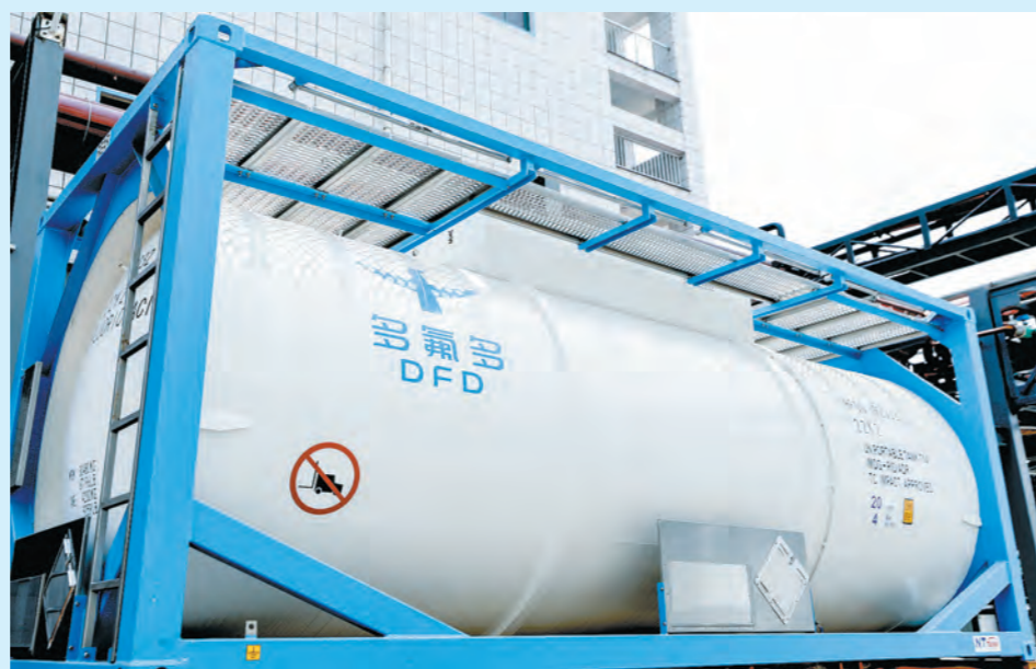
电子级氢氟酸产品 ISO Tank 包装。
