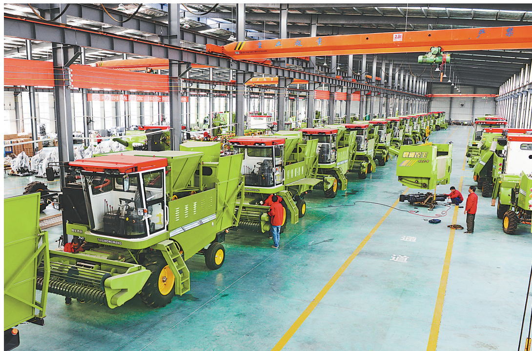
8月14日,焦作泰利机械制造有限公司的工人在组装农机。该公司位于沁阳经济技术开发区,经过发展壮大,目前年可生产小麦收割机、花生捡拾收获机等农业收获机械5000余台,年销售收入达1.4亿元。 本报记者 刘金元 摄
