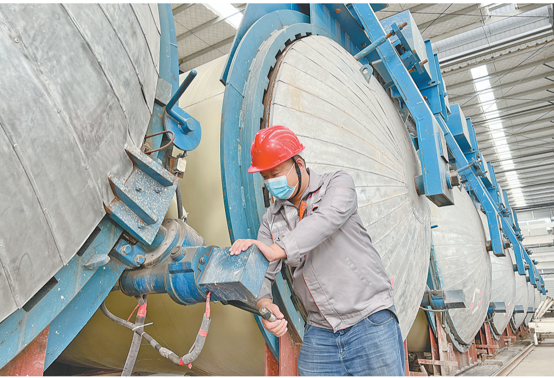
11月15日,位于修武县七贤镇中州铝业转型示范园区的河南新美家节能材料科技有限公司生产厂区内,一派忙碌生产的景象。该公司高标准引进国内先进的技术设备和生产线,利用中州铝厂的赤泥(年消化赤泥50万吨)、浮选尾矿、粉煤灰等一般固废,生产装配式绿色环保新型墙体建筑构件——蒸压加气混凝土板材,年产能120万立方米。
