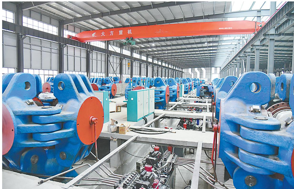
3月10日，焦作天宝恒祥机械科技有限公司超硬材料智慧谷项目现场，技术人员正在安装调试六面顶压机。该项目总投资25亿元，建成后将成为行业领先的超硬材料装备和产品生产基地，形成完整的人工钻石全产业链，预计年产值达50亿元。
