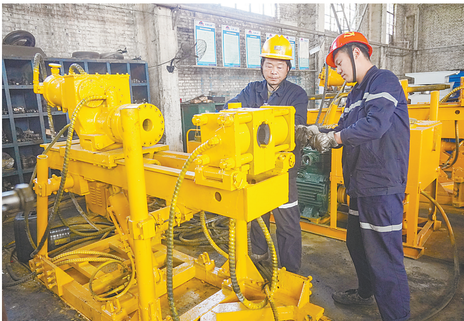
4月26日,焦煤集团九里山矿机修职工在维修4000S型钻机现场。今年年初以来,该矿从源头控制、修旧利废、设备管理等多维度入手,通过开展修旧利废活动、修订管理办法、制定考核流程,将费用指标细化到每一个班组、每一名职工。 郭董 摄
