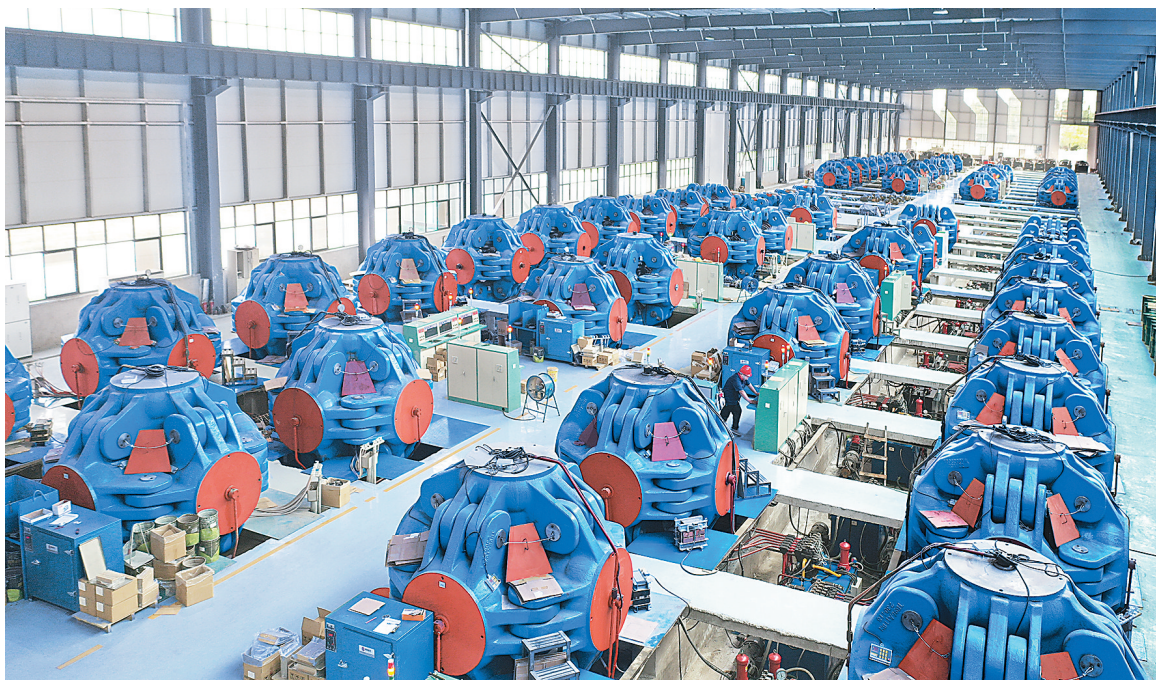
6月29日，焦作天宝恒祥机械科技有限公司技术人员在调试六面顶超高压合成装备。该公司超硬材料智慧谷项目一期工程，设计安装200台（套）六面顶压机，其中35台设备已经试生产。项目全部建成投产后，这里将成为国内领先的超硬材料装备和产品生产基地。 本报记者 刘金元 摄
