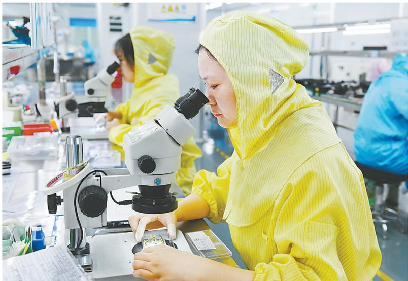
11月5日,位于修武经济技术开发区的河南鑫宇光科技股份有限公司工人在生产空间隔离器。为拉长通讯产业链条,该公司自主投资建设光子创客空间,先后引进炭博通讯、瑞创光电、安立文光电等上下游企业,通过产品研发、人才培养、资金投入,孵化培育一批生产性企业,形成年产1500万只隔离器规模,产能位于国内同行第一、全球第二。
