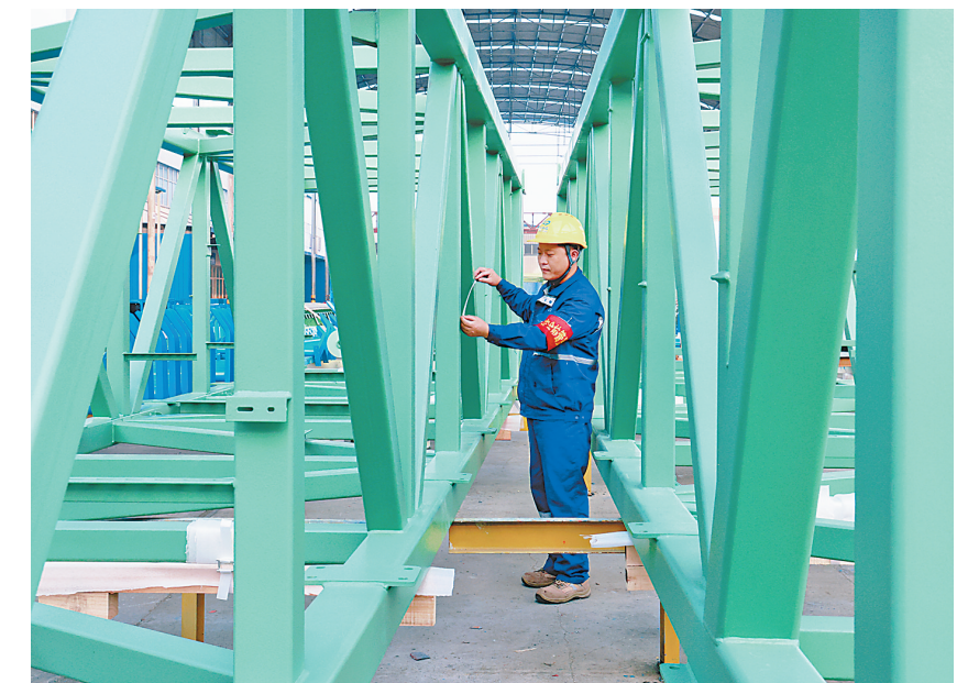
12月12日,焦作科瑞森重装备股份有限公司生产车间的工人正在进行桁架涂装外观自检。该公司是散料输送装备领域“深耕者”,产品覆盖矿山、港口等领域并远销海内外,凭借严格的品质控制赢得市场认可。本报记者马雅宁 摄
