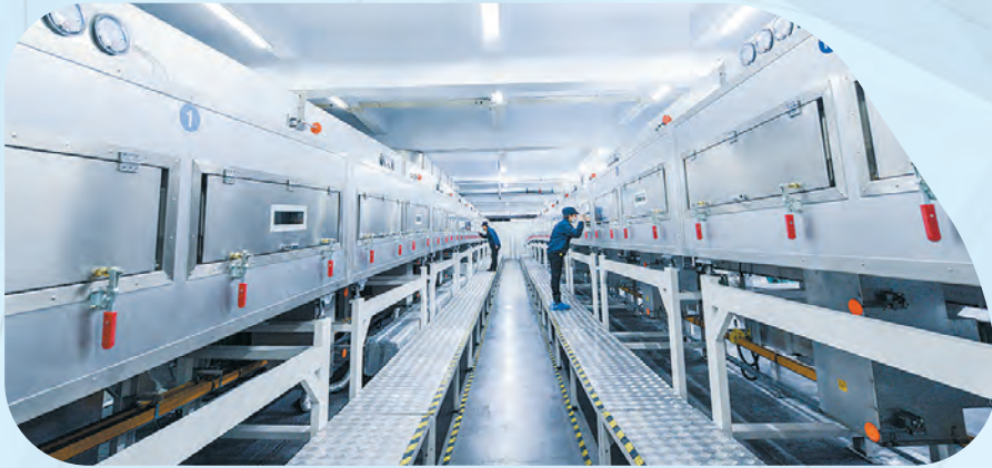
多氟多新能源锂电池生产线工人在对电池配件进行烘干处理。
