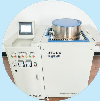
化学分析试样熔样炉
