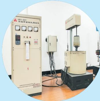
荷重软化温度检测仪
