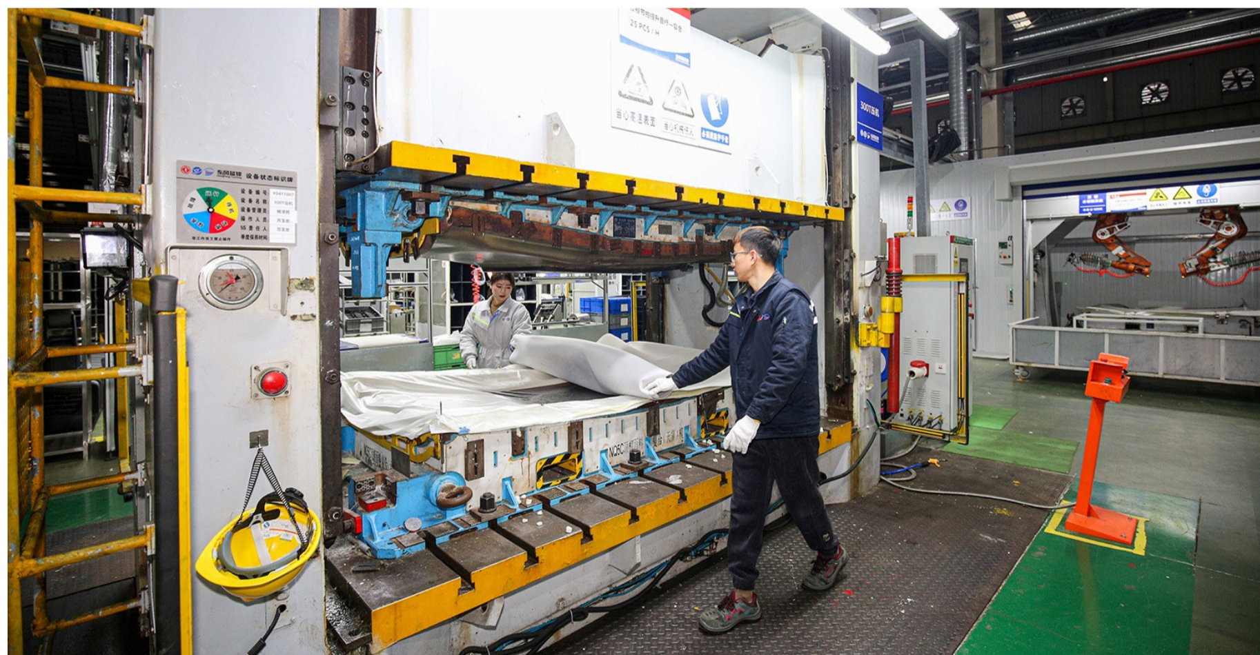
东风延锋盐城汽车座舱系统有限公司主要从事汽车门板、通道、顶棚等汽车内饰件的研发、生产和销售，是悦达起亚的一级配套商。今年一季度，该公司开票销售同比增长31%，当前，公司上下正紧紧围绕全年目标任务，开足马力忙生产、赶订单，全力为客户提供更有竞争力的智能内饰产品和技术服务，为公司发展注入源源不断的活力。图为工人操作顶棚压膜设备。 蔡玉成 摄
