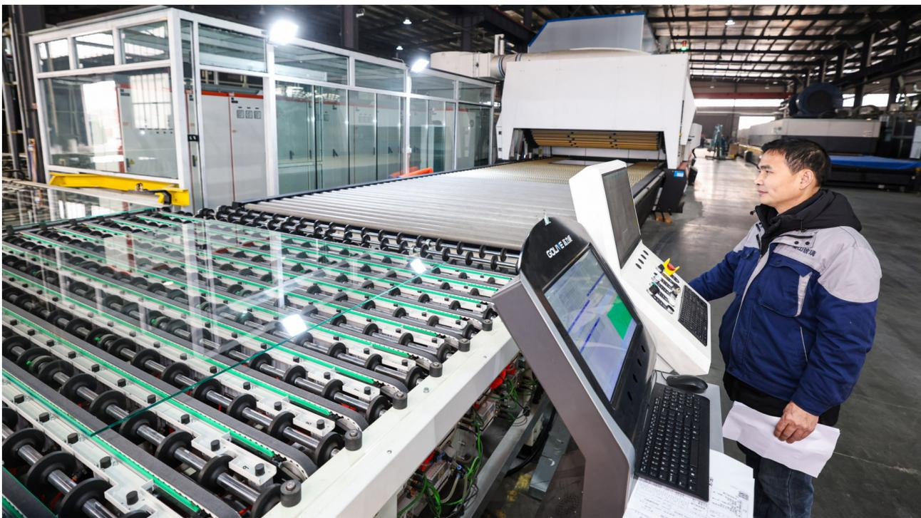
江苏泰山玻璃科技有限公司是一家专注于精品家装玻璃深加工的企业，具备年产30万平方米家装玻璃的产能。近年来，该公司紧扣高质量发展要求，加快推进企业向高端化、智能化、绿色化转型，以智能车间建设为抓手，不断提高生产质量和效率。2024年，公司实现年开票销售同比增长20%。图为工人操作玻璃钢化炉。 蔡玉成 摄
