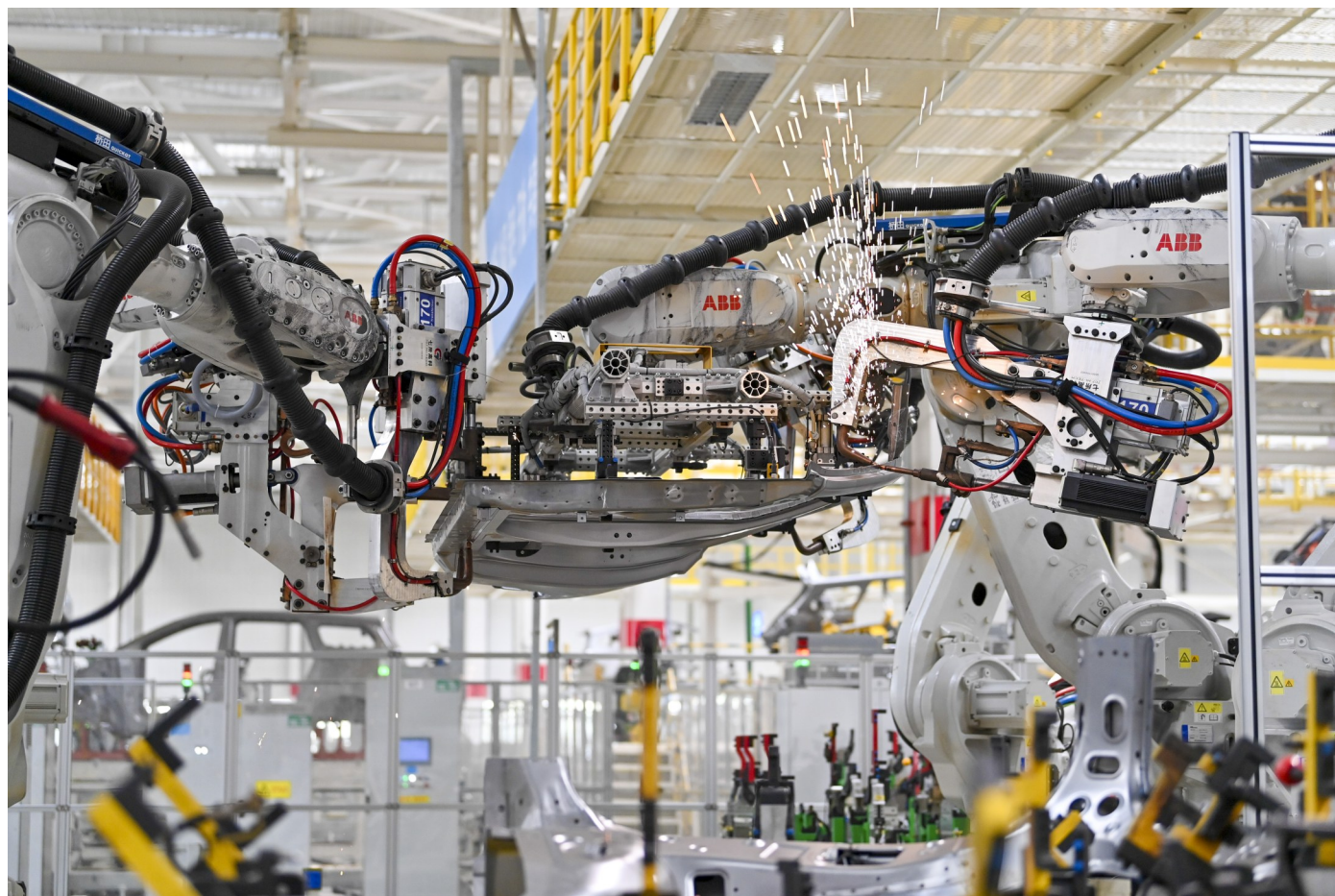
在一新能源汽车生产基地,智能焊接机器人在作业。 □新华社记者 杨晨光 摄
