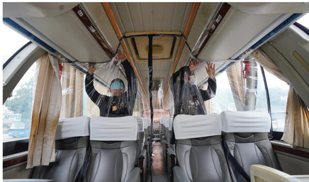
近日,县交通运输部门为疫情防控转运专用车安装隔离防护膜,在承接转运的工作人员与被转运人员之间,拉起一层保护网,有效切断转运过程中工作人员与被转运人员间的病毒传播途径,更好地保护司乘人员的安全,防止交叉感染,高效有序地保障运转工作。
